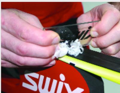
**6.** Если нанесённая мазь жесткая, CH4/CH6, LF4/LF6 или HF4/HF6, то снимите большую часть мази пока она ещё мягкая, до того, как она полностью остынет. После остывания продолжите обработку острым пластиковым скребком. Остальные, более мягкие мази, (индексы 7, 8, 10) обрабатывайте скребком в остывшем состоянии. Другие мази CH7/CH8/CH10, LF7/LF8/LF10 или HF7/HF8/HF10 снимаются скребком после того, как лыжа остынет до комнатной температуры (5 минут).
