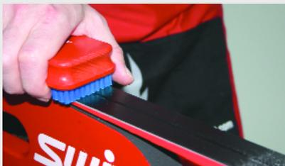
1. Вычистите структуру скользящей поверхности тонкой стальной щеткой (T192 или T197). Примерно 10-20 проходов.
