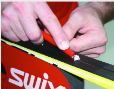
**5.** Не забудьте удалить излишки мази с боковин лыж и из желобка (пользуйтесь скребком T0087 или T0088). При обработке желобка скребок может сорваться и оставить царапину на поверхности базы, поэтому рекомендуем обработать сначала его.
