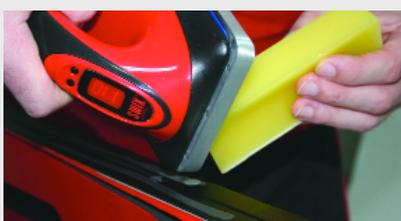
**3.** Нанесите мягкую мазь (CH10) для насыщения материала базы. Температуру утюга необходимо выбрать так, чтобы обеспечить мгновенное плавление мази - около 115°C.
