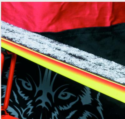
1. Распределите порошок Cera F ровным слоем по поверхности базы. Порошка должно быть нанесено достаточно, чтобы предотвратить непосредственный контакт утюга с базой.
