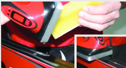
**1.** Начните с очистки базы мазью методом горячего циклевания. После машинной обработки камнем может остаться грязь. Нанесите мягкую мазь (CH10) для насыщения материала базы. Температуру утюга необходимо выбрать так, чтобы обеспечить мгновенное плавление мази - около 115°C.
