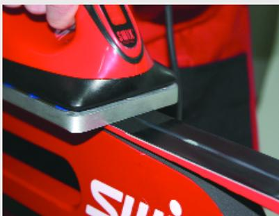
**4.** Температура утюга должна быть достаточной для плавления мази, но при этом не должен появляться дым. Вплавляйте мазь, равномерно проводя утюг от носка к пятке. Повторите 2-3 раза и дайте лыжам остыть до комнатной температуры.
