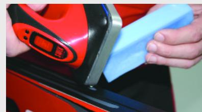
**8.** Нанесите более твердую мазь LF6, вплавьте. Температура утюга приблизительно 140°C.
