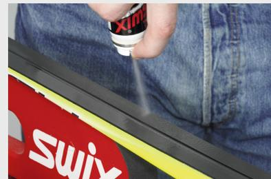
1. Нанесите ровный слой спрея FC8A на скользящую поверхность вдоль обеих сторон от желобка. Расстояние между дозатором и базой лыжи должно быть примерно 4-5 см. Флакон располагается перпендикулярно. Время высыхания нанесенного спрея 5 мин.
