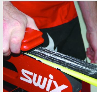
3. Остудите лыжу в течение 5 минут. «Приподнимите» порошок щеткой из жесткого черного нейлона (T194), 10 проходов.
