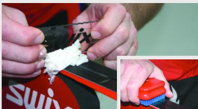
**2.** Соскребите мазь, пока она мягкая, с помощью пластикового скребка (метод горячего циклевания). Давление должно быть легким! Используйте бронзовую щетку средней жесткости (T162) или стальную щетку средней жесткости (T179).
