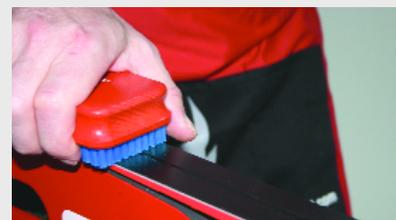
**7.** Используйте бронзовую щетку средней жесткости (T162) или стальную щетку средней жесткости (T179). Обработка производится движениями в направлении от носка к пятке, 5-10 движений.
