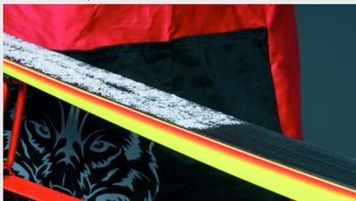
1. Нанесите ровным слоем порошок Cera F на лыжу. Вы можете зафиксировать порошок на лыже с помощью утюга, быстро пройдясь горячим утюгом в течение 3 секунд при температуре 150°C.
