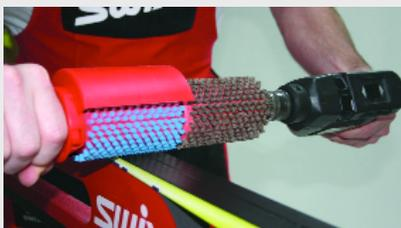
4. Завершите обработку белой нейлоновой вращающейся щеткой T17W. Два плавных прохода щеткой от носка к пятке за 4-5 секунд. (Внимание! Не используйте те же щетки, что и для обычных масел.) Работайте с легким нажимом. Также можно использовать ручную щетку с набивкой из голубого нейлона (T160). 3-4 движения.
