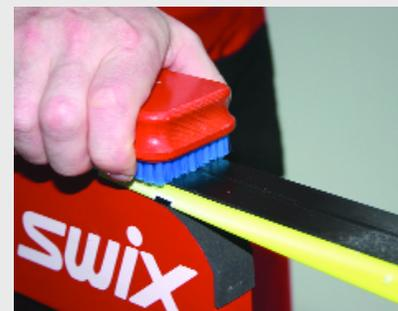
**7.** Обработайте базу бронзовой щеткой средней жесткости (T162) или стальной щеткой средней жесткости (T179).
